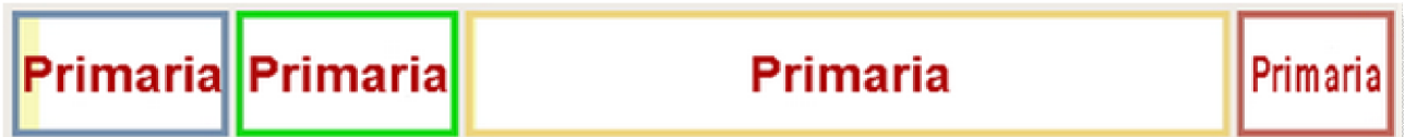
Fig. 4: Disco completamente occupato da quattro partizioni primarie, abbiamo raggiunto il limite massimo.
